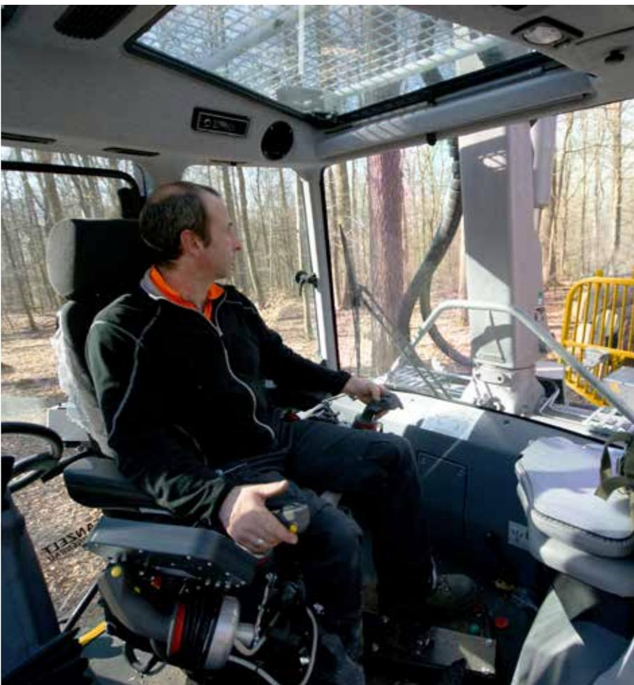
Eine entspannte und ergonomische Sitz- und Arbeitsposition findet der Fahrer auf dem nun um 350° elektrisch drehbaren, luftgefederten Bedienerstand. Auch bei der Konfiguration der Kabine mit zwei vollwertigen Sitzen sind diese luftgefedert.
