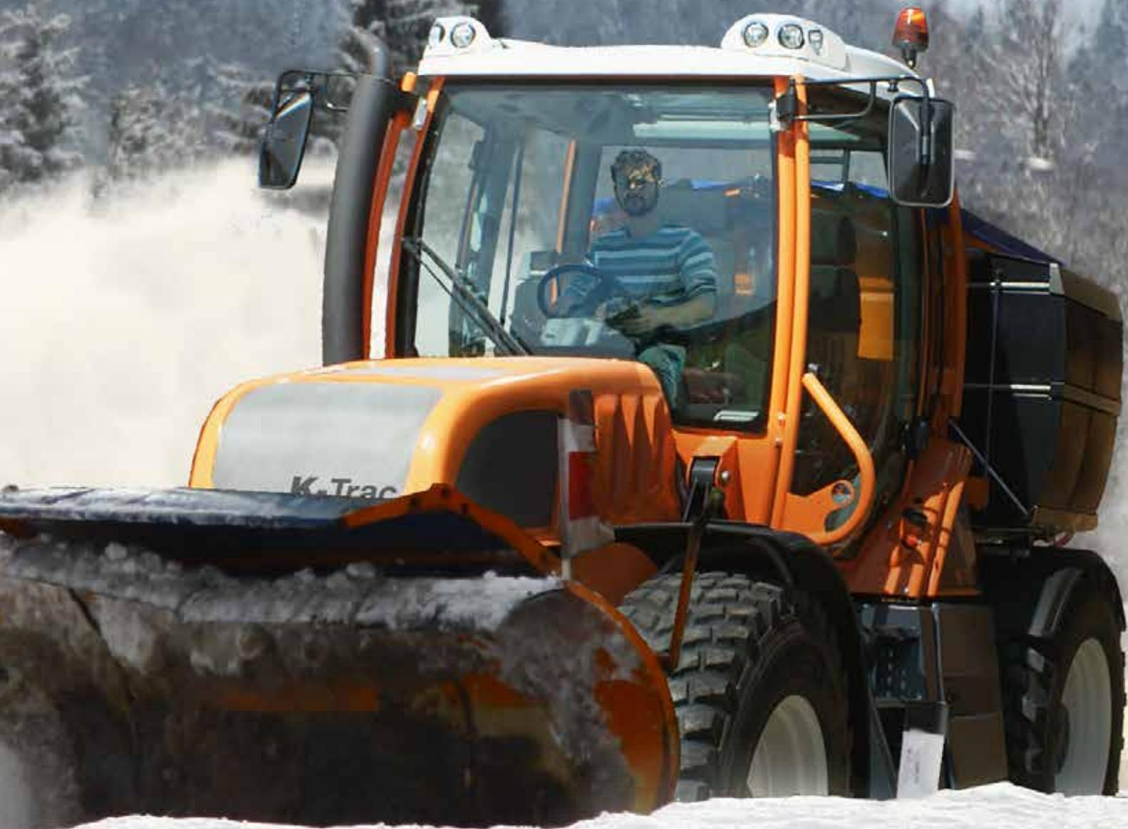
... Gelenkt wird per Joystick, über den auch alle anderen Funktionen bedient werden können. [...] „Ich kann das Lenkrad samt Lenksäule ganz nach vorne klappen, um Platz für den drehbaren Bedienstand zu schaffen“, argumentiert er und verät: „Dieser ist der Clou des Pm Tracs.“ Der Bedienstand ist elektrisch in jede Richtung drehbar, sodass Lehmann auch quer zu Fahrtrichtung sitzen und seine seitliche Arbeit besser im Blick haben kann. ...
